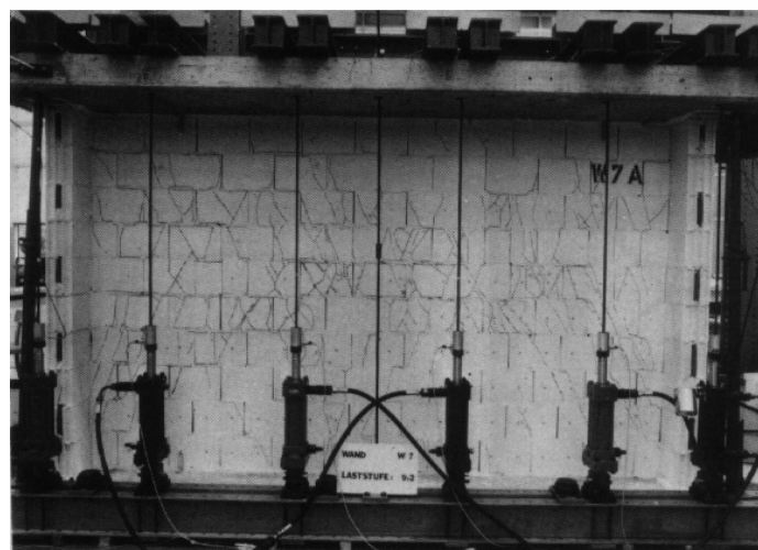
Figura 1.69 - Condición final de daño (especímenes W5, W6 y W7)
